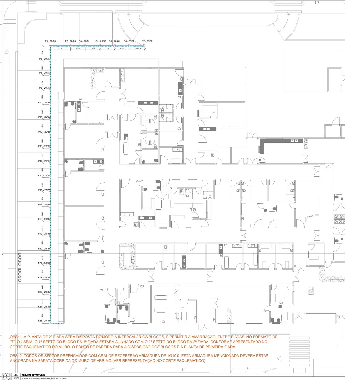
OBS: 1. A PLANTA DE 2ª FIADA SERÁ DISPOSTA DE MODO A INTERCALAR OS BLOCOS, E PERMITIR A AMARRAÇÃO, ENTRE FIADAS, NO FORMATO DE "T" OU SEJA, O 1º SEPTO DO BLOCO DA 1ª FIADA ESTARÁ ALINHADO COM O 2º SEPTO DO BLOCO DA 2ª FIADA, CONFORME APRESENTADO NO CORTE ESQUEMÁTICO DO MURO. O PONTO DE PARTIDA PARA A DISPOSIÇÃO DOS BLOCOS É A PLANTA DE PRIMEIRA FIADA.
