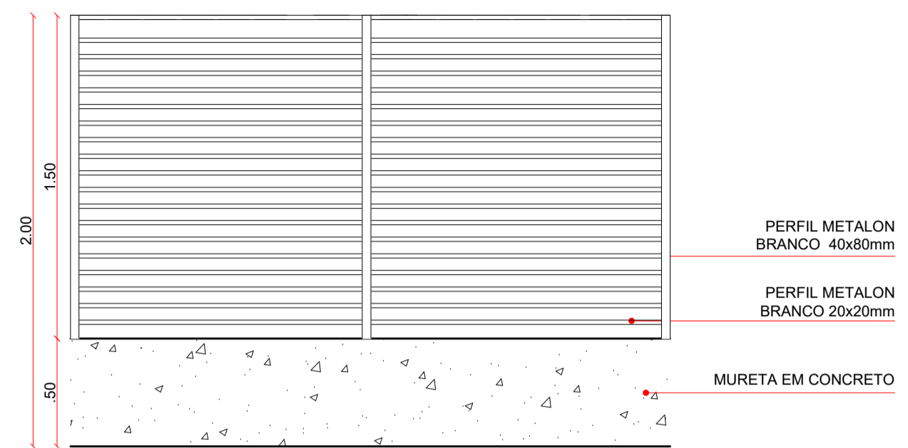
DET. MURETA COM GRADIL ESCALA 1:25
